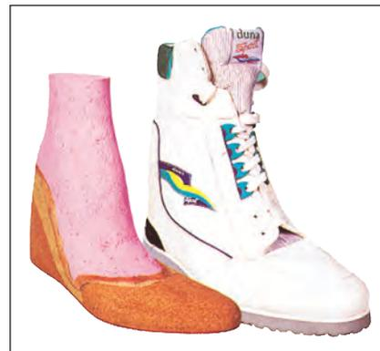
È costruita su forme di legno o calco di gesso negativo e positivo o materiale sintetico opportunamente stilizzato, previo rilievo del grafico e delle misure del piede.
